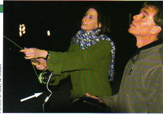
Professor Perkins analysiert mit Hilfe des neuen „Casting Analyser“ bei einer Fliegenfischerin die Wurftechnik. Das kleine Sensor-Gerät (Pfeil) an der Rute registriert den kompletten Wurfablauf und analysiert Wurf Fehler.
